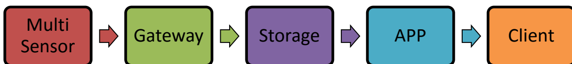
รูปที่ 49 การไหลของข้อมูลจากมัลติเซนเซอร์ไปแสดงผลที่ Client
