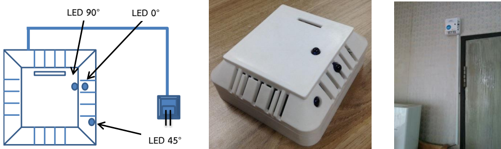
รูปที่ 20 รูปมัลติเซนเซอร์และตัวควบคุมเครื่องปรับอากาศ พร้อมตัวอย่างการติดตั้ง
