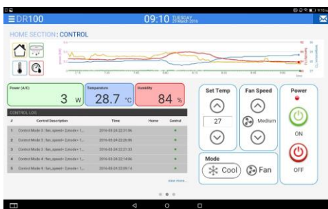
รูปที่ 45 หน้าแสดงการควบคุมการทำงาน ของเครื่องปรับอากาศภายในบ้าน
