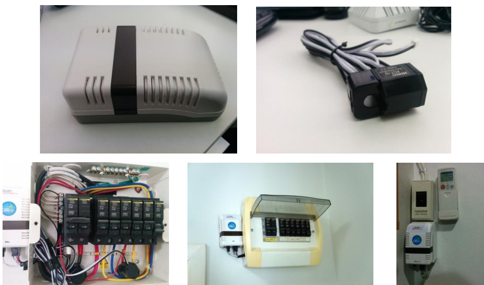
รูปที่ 21 รูปภาพมิเตอร์อัจฉริยะ พร้อมตัวอย่างการติดตั้ง
