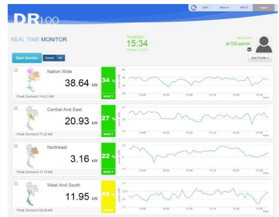
รูปที่ 38 หน้าแสดงกำลังไฟฟ้าเพื่อติดตามผลการควบคุมของโหมดควบคุมอัตโนมัติอย่างใกล้ชิด
