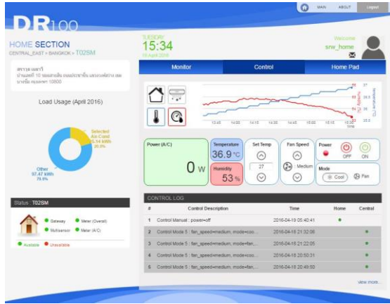
รูปที่ 35 หน้าแสดงการควบคุมการทำงานของเครื่องปรับอากาศภายในบ้าน
